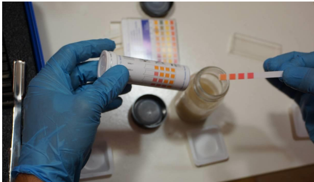
Metoda badania soli w próbkach tynku – fotografia z archiwum Autora
